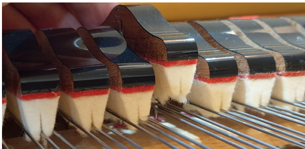
Uszkodzony filc tłumików
